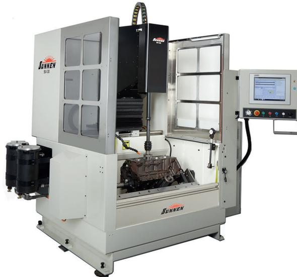
und 40 m/min. Ein leistungsstarker 7,0-kW-Spindelmotor, der an ein spezielles Getriebe gekoppelt ist, beschleunigt das eingesetzte Werkzeug auf maximal  $450 \text{ min}^{-1}$ . Durch den starken Spindelmotor lassen sich mit der HTC Abtragsleistungen von bis zu  $1000 \text{ cm}^3/\text{h}$  realisieren. Features wie zum Beispiel eine automatische Bohrungsgeometriekorrektur oder eine Konusbearbeitung, wie auch ein Werkzeug-Überlastschutz sorgen für die nötige Prozesskontrolle. ■
